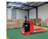
AGV搬运车本体
